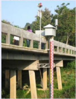
สถานีเตือนภัยด้วย ปริมาณน้ำฝนและระดับน้ำ
